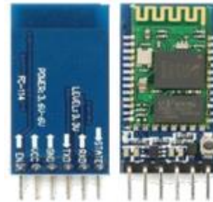
Fig:HC-05 Bluetooth Module
