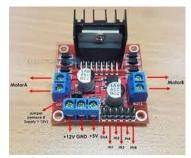
Fig.3.7: L298N Motor Driver IC
