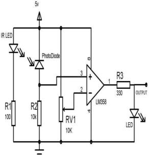
Fig. 4 IR Sensor Module Circuit Diagram
