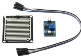
Fig. 4. Rain sensor module
