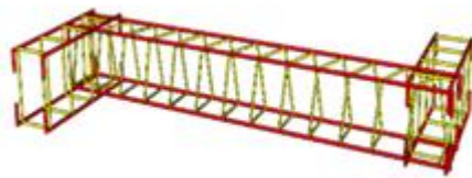
c) B3 - Inclined type Stirrups(75°)
