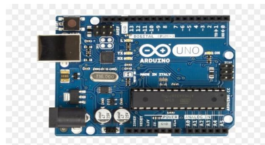
Fig 1: Arduino Uno R3
