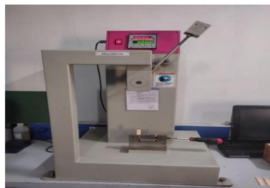
Fig. 5: Izod Impact Tester.
