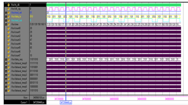
Fig 3 Simulation output of OOK modulator
