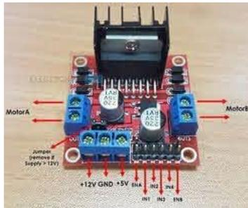
Fig.3.7: L298N Motor Driver IC
