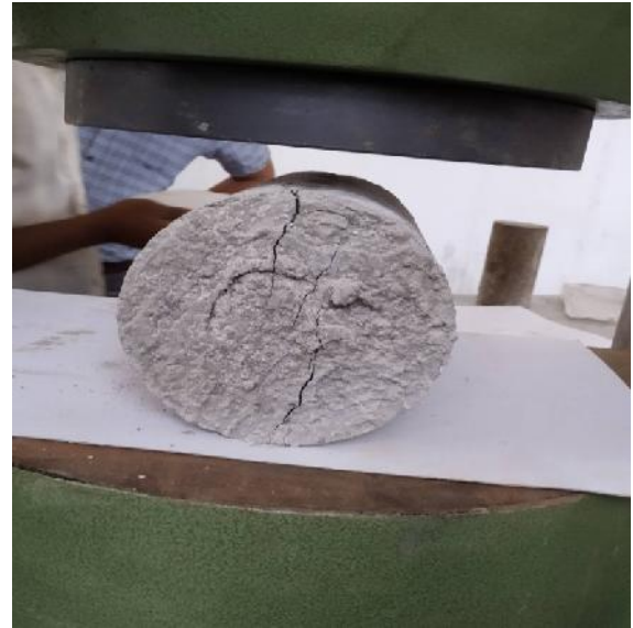
Figure 3.3 – Spilt Tensile Test
