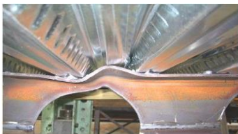
Fig-1.4 vierendeel mechanism
