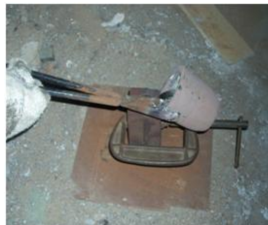
Fig 3.3 molten metal pouring to the die
