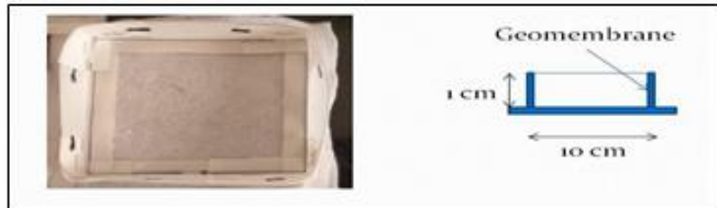
Fig.3.2(c) Attaching Geomembrane
