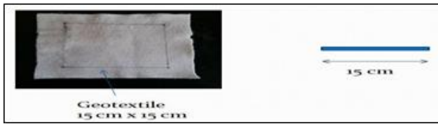
Fig.3.1(c) Geotextile Layer
