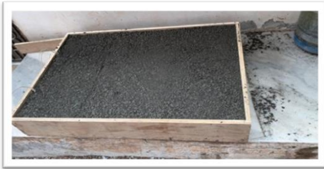
Step 5:- Layer of Asphalt.
