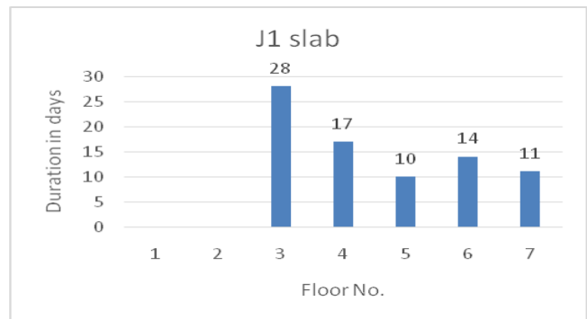
Figure no 2: Actual slab cycle
