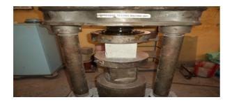
**Cube Compression Test Apparatus**
