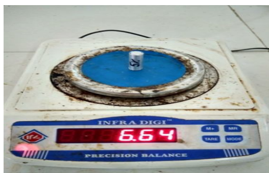
Figure1 (d) Weighing after wear test
