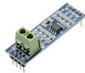
Fig 3. Module of RS 485.
