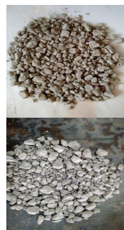
(c) processed concrete (d) recycled
