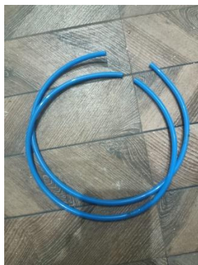
Fig.3 PU PIPES (6x4mm)
